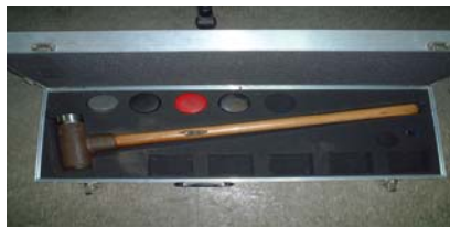
圖五. 以大型 hammer 敲擊固定隔音牆框架之底座 圖六. 試驗場量測背板結構振動頻譜圖
