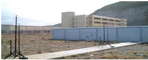
圖十六.安裝隔音牆後 OR25 與 NA-27 交互比對量測圖
