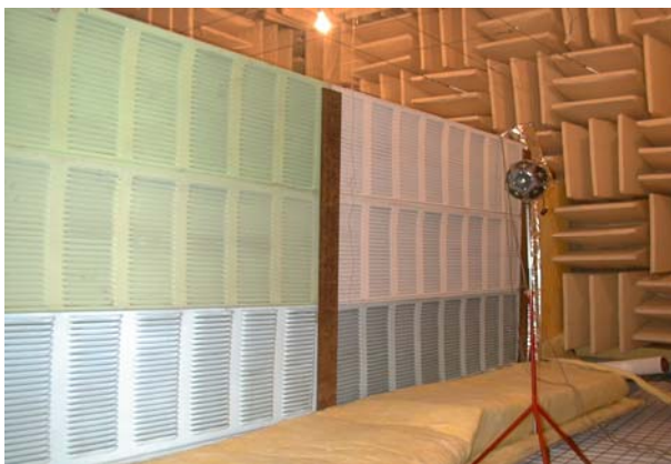
圖 8 無響室全尺寸防音牆插入損失量測
