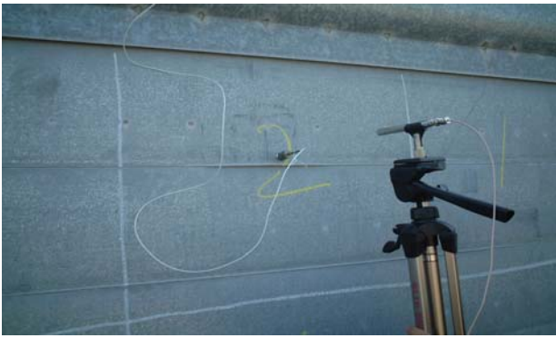
圖 11 (b)戶外全尺寸防音牆量測
