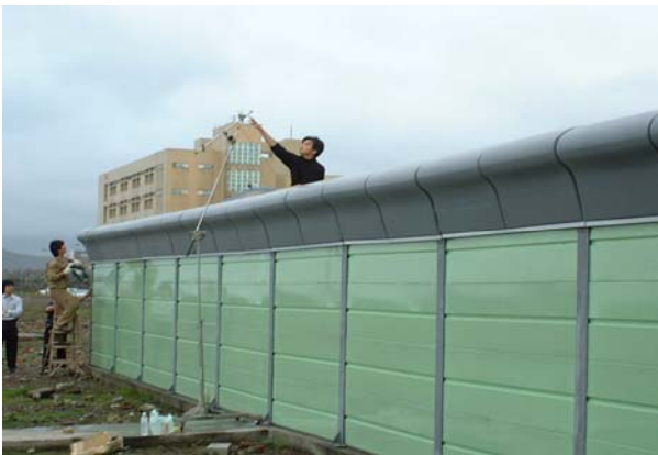
圖 23 以校正用麥克風調整音源功率大小
