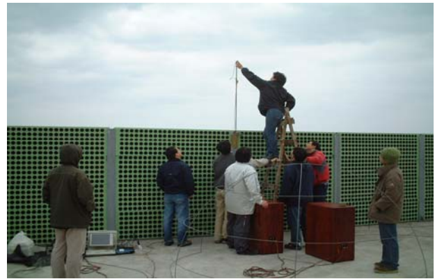
圖 20 防音牆頂校正用麥克風安裝位置示意圖
