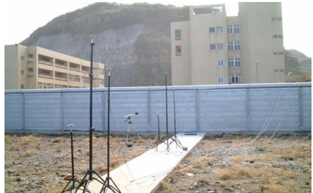
圖 21 頂緣消音裝置安裝前量測音壓圖
