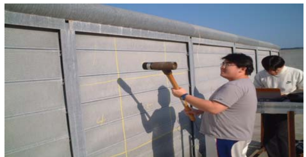
圖 11 (a) 戶外全尺寸防音牆量測
