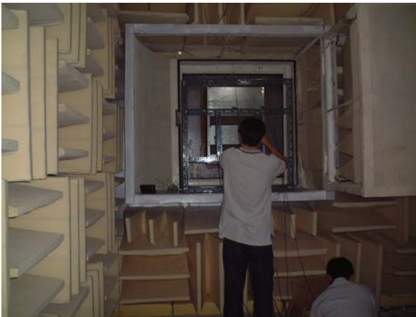
圖 12 (b)實驗室內穿透損失測試窗量測
