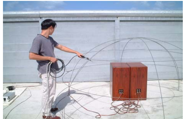
圖.15 (a)以音源產生器激發防音牆背板結構輻射音壓實驗圖
