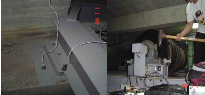
圖 10. 停車塔減速馬達振動與動性傳遞頻譜量測
